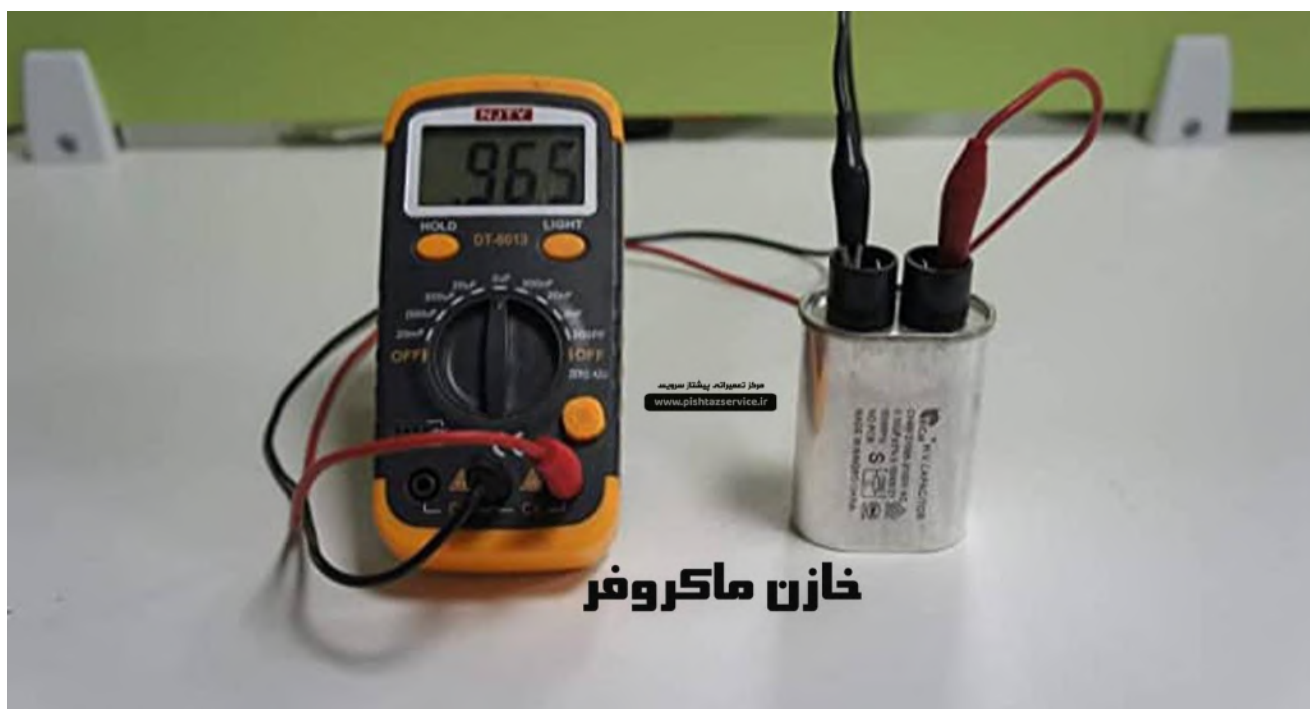
تست خازن به وسیله مولتی متر
